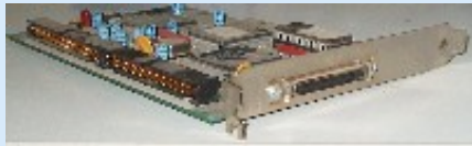
Carte SCSI 2 Adaptec AH 3940. Cette carte est identique à une 2940 mais possède 2 canaux internes distincts (RAID)
